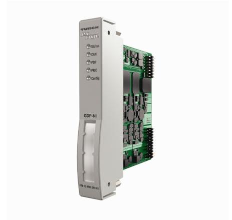
Шлюз GDP-NI служит для подключения excom® для сетей PROFIBUS-DP. Подключение к PROFIBUS-DP может быть организовано через оптоволоконный или медный кабель. При использовании оптоволоконной для передачи данных быть установлен оптокоммутатор между медной линией и оптоволоконном подключенным к PROFIBUS.
