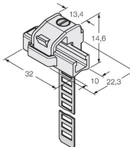
Монтажный кронштейн для установки датчиков магнитного поля на круглые цилиндры; диаметр цилиндра: 130...250 мм; материал: PA 6I/6T / мельхиор; классификация воспламеняемости в соотв. с UL94 - V2
