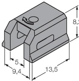
Монтажный кронштейн для установки датчиков магнитного поля на цилиндры с пазом типа "ласточкин хвост"; ширина паза: 9,4 мм; материал: PPS
