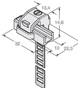
Монтажный кронштейн для установки датчиков магнитного поля на круглые цилиндры; диаметр цилиндра: 25...63 мм; материал: PA 6I/6T / мельхиор; классификация воспламеняемости в соотв. с UL94 - V2
