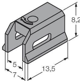
Монтажный кронштейн для установки датчиков магнитного поля на цилиндры с пазом типа "ласточкин хвост"; ширина паза: 7 мм; материал: PPS
