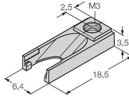
Аксессуары для фиксации точки переключения на цилиндрах с Т-образным пазом; защелкивается в паз; материал: Пластмасса
