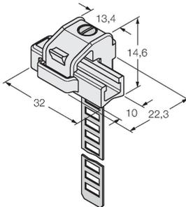
Монтажный кронштейн для установки датчиков магнитного поля на круглые цилиндры; диаметр цилиндра: 8...25 мм; материал: PA 6I/6T / мельхиор; классификация воспламеняемости в соотв. с UL94 - V2
