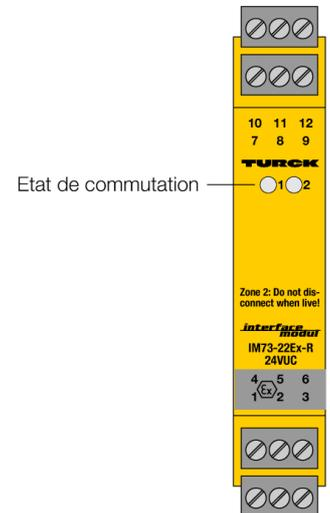
Le coupleur à relais à 2 canaux IM73-22EX-R/24VUC est utilisé pour la commutation de circuits de courant à sécurité intrinsèque et garantit une séparation galvanique sûre entre les circuits de contact et de commande suivant EN 60079-11.
