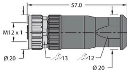
Connecteur femelle confectionnable, M12 x 1, droit, 4 pôles, raccordement par borne à vis, diamètre de ligne 4.0 à 8.0 mm, section conducteur/section raccordable 0,25 à 1.5 mm<sup>2</sup>, boîtier plastique, écrou de montage métallique
