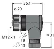
Connecteur femelle confectionnable, M12 x 1, coudé, 4 pôles, raccordement par borne à vis, diamètre de ligne 4.0 à 6.0 mm, section conducteur/section raccordable 0,25 à 0.75 mm<sup>2</sup>, boîtier plastique, écrou de montage métallique
