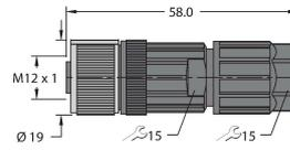
Connecteur femelle confectionnable, M12 x 1, droit, 4 pôles, raccordement Push-In, diamètre de ligne 4,0 à 8,0 mm, section conducteur/section raccordable 0,14 à 0,75 mm<sup>2</sup>, boîtier plastique, écrou de montage métallique
