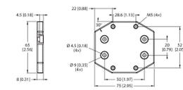
Plaque d'adaptation pour le montage du boîtier QR20 avec trous de montage pour le boîtier Q20L60
