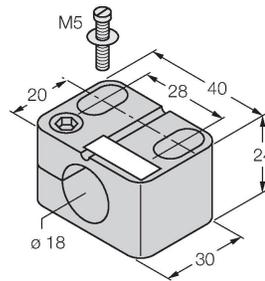
Abrazadera de montaje para sensores de tubo roscado, sin tope fijo; material: PA6
