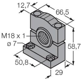
ángulo de montaje, negro PBT, para rosca de 18mm
