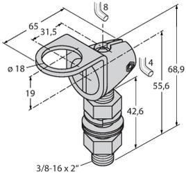
ángulo de montaje; material VA 1.4401, para rosca de 18mm
