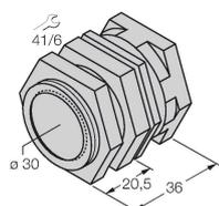
Abrazadera de montaje rápido con tope, material: Latón cromado. Rosca macho M36 x 1.5. Nota: La distancia de conmutación de los interruptores de proximidad puede variar por el uso de soportes de montaje rápido.
