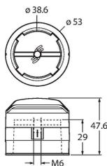
Actuador (puck) para sensores dobles; posición final activada; patrón de agujeros en la superficie del receptáculo: 80 x 30 mm y 130 x 30 mm; altura del eje de conexión (extensión del eje): 30 mm/Ø: máx. 35 mm; disponible como opción: Espaciador BTS-DSC26-UR10 para ejes de conexión de 20 mm de alto (extensión del eje)
