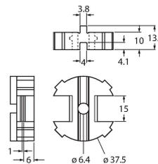
Espaciador para el kit de activación del sensor dual BTS-DSC26-EB20
