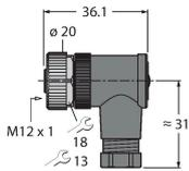
Konfektionierbare Kupplung, M12 x 1, gewinkelt, 4-polig, Schraubklemmanschluss, Leitungsdurchlass 4.0 bis 6.0 mm, Adernquerschnitt/Klemmvermögen 0.25 bis 0.75 mm<sup>2</sup>, Kunststoffgehäuse, Metallüberwurfmutter
