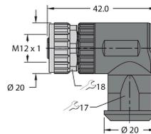
Konfektionierbare Kupplung, M12 x 1, gewinkelt, 4-polig, Schraubklemmanschluss, Leitungsdurchlass 4.0 bis 8.0 mm, Adernquerschnitt/Klemmvermögen 0.25 bis 1.5 mm<sup>2</sup>, Kunststoffgehäuse, Metallüberwurfmutter
