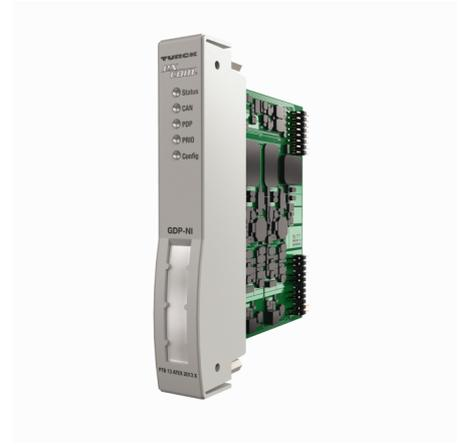
网关GDP-NI用于将excom® 系统连接到 PROFIBUS-DP系统中。可使用光纤或铜芯电缆与PROFIBUS-DP建立连接。当使用光纤用于数据传输，需要使用一对光纤连接铜介质 PROFIBUS网络。
